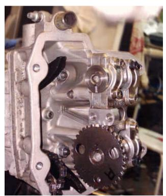
5. Schraube von Einlassnockenrad lösen und Zahnrad von der Welle ziehen. Steuerkette festbinden, damit sie nicht ins Gehäuse fällt.
