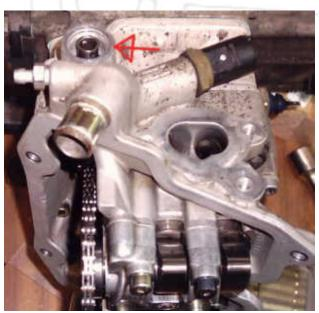
3. Abdeckung des Kettenspanners lösen und Kettenspanner durch nach oben drücken der Spannschiene herausdrücken.
