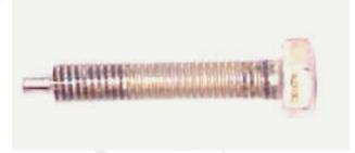
2. Motor an einer Nockenwelle auf OT drehen ( Nockenwellenspitzen aussen). OT Fixierschraube mit Hand eindrehen und durch leichtes Bewegen der Nockenwelle die Spitze der OT Fixierschraube in die Nut der Kurbelwelle eindrehen. Nun Schraube leicht anziehen.
