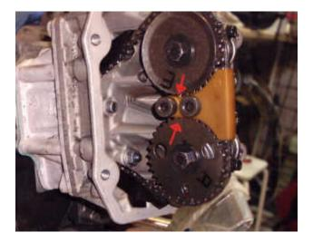
8. Nockenwellenbrücken und Nockenwellen wieder einbauen - darauf achten, dass die Nockenwellenbrücken fluchten!!
